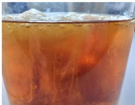
Abbildung 1: Koagulation - Verklumpung durch Interaktion zwischen Polymeren und inkompatiblen Stoffen eines zweiten Schaumlöschmittelkonzentrates
